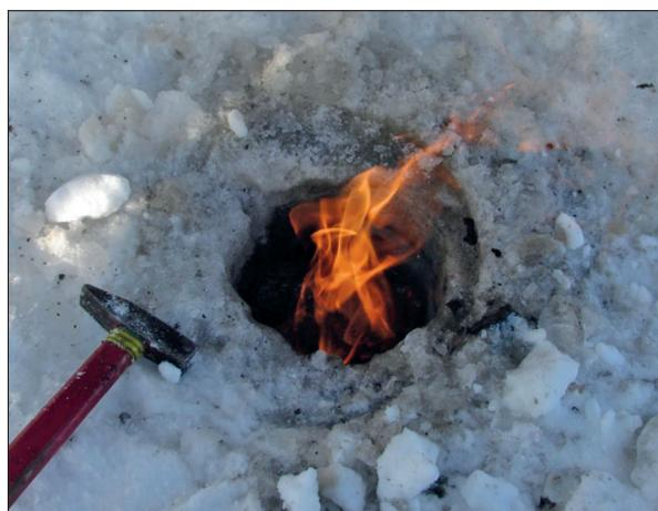
**Рис. 6.** Выброс природного газа из скважины 1с-16, поднимающегося из пробуренных талых подрусловых грунтов через толщу речной воды.
