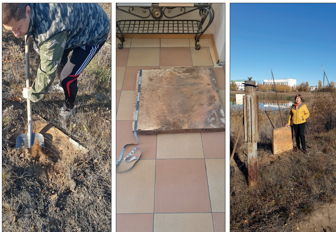
Рис. 3. Фрагменты взятия образца пенопластовой плиты с поверхности дамбы на территории института. Сентябрь 2024 г.
