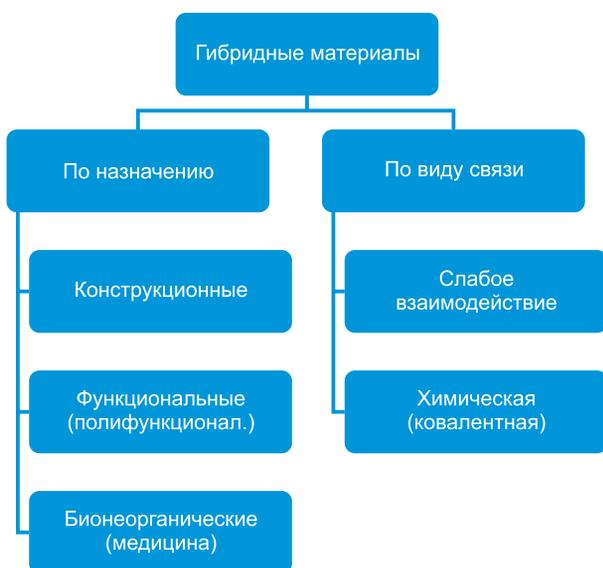
Рис. 1. Классификация гибридных материалов по назначению и виду связи
