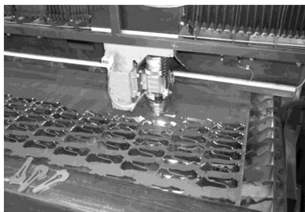
Рис. 1. Схема процесса (а) и применение технологии лазерной резки в изготовлении корпуса хомуса (б)
