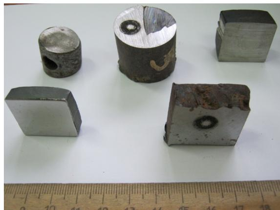
Рис.5. Образцы выплавленных хладостойких и высокопрочных сталей
