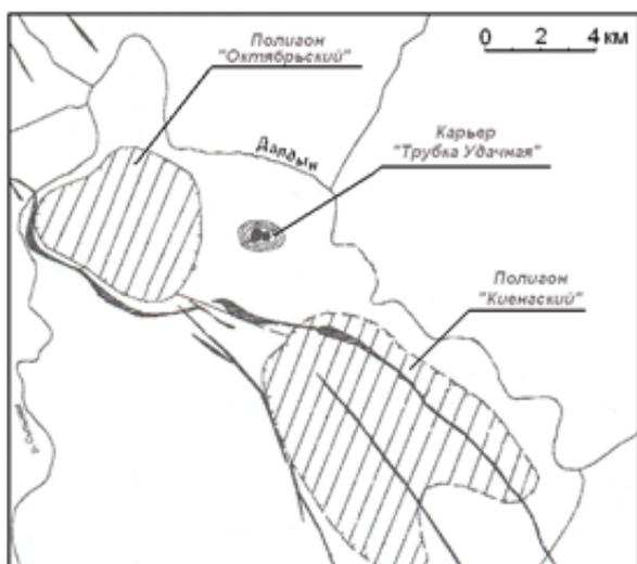
Рис. 1. Расположение полигонов подземного захоронения рассолов карьера трубки «Удачная» [15]
