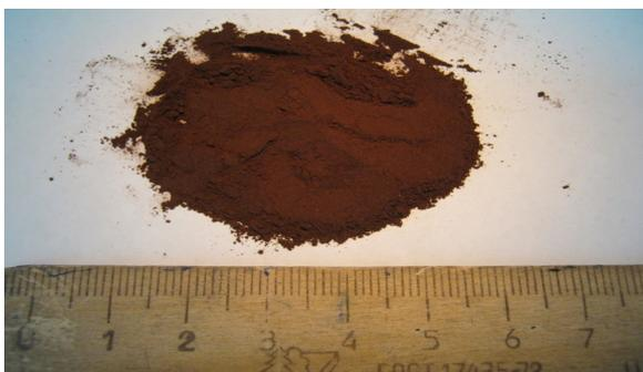
**Рис.4.** Обогащенная и измельченная железомарганцевая руда, как готовая шихта для последующей плавки
