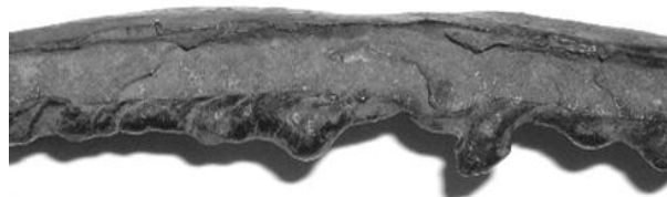
Рис 5. Излом очага разрушения магистрального газопровода. Вторая авария
