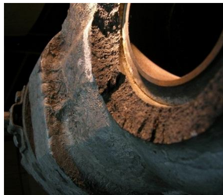
Рис. 3. Строение излома задвижки фонтанной арматуры
