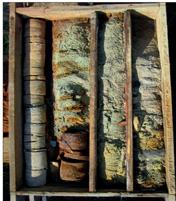
Рис. 6. Пример трещинно-пластового окисления по древней плащевидной коре выветривания, охватившей известковистые глинистые породы кембрия. Осветленные алевролиты ботуобинской свиты с пятнистой лимонитизацией и осветленные также с пятнами лимонита рыхлые известковистые глины и гетит-гематит-сидеритовый агрегат мощностью 30 см в коре выветривания, Скважина 74,925–234,5, интервал 16–20 м
