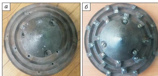
**Рис. 4.** Рабочие органы ступенчатой мельницы с дополнительными отбойными элементами: *a* – без отбойных элементов; *б* – с установкой 8 отбойных элементов.
