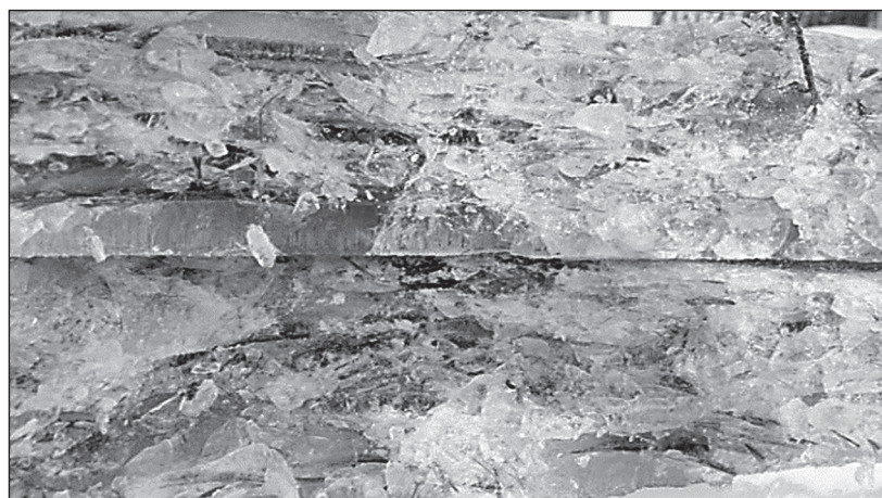
Рис. 9. Структура поверхности разрушения ледового композита с содержанием базальтовой фибры 2,25 об. %
