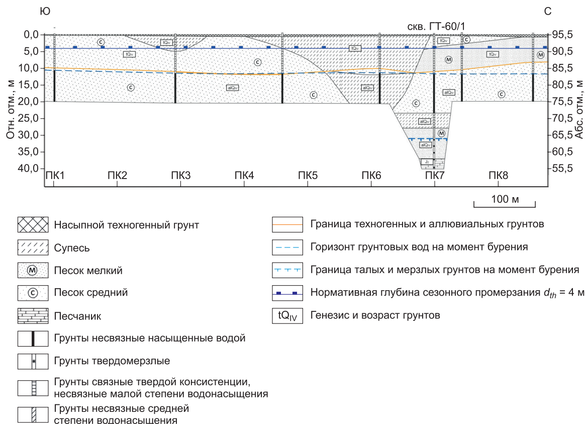
Рис. 6. Инженерно-геокриологический разрез по продольному профилю дамбы
