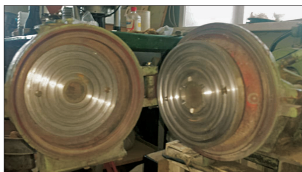
Рис. 3. Рабочие органы и рабочая камера лабораторной модели измельчителя.
