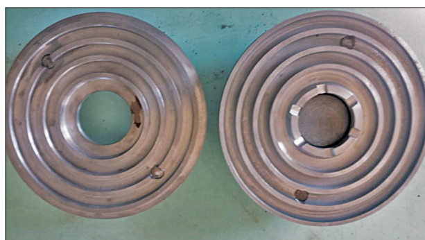
Рис. 3. Рабочие органы и рабочая камера лабораторной модели измельчителя.
