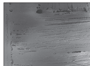
Рис. 3. Поверхность образцов (×35) пластиков после 2 лет экспозиции в экстремально холодном климате г. Якутск.
