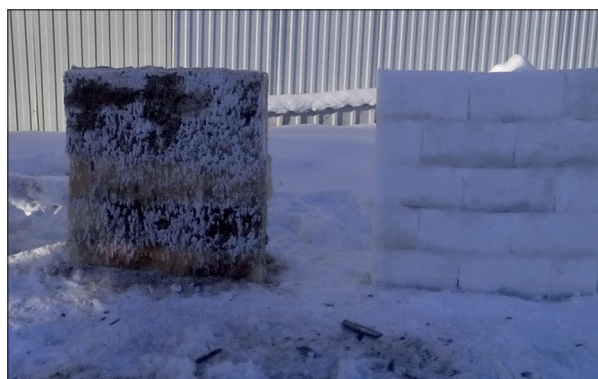
Рис. 1. Макеты стеновых конструкций из снеговодяных (справа) и снеговодяных с добавкой опилок (слева) блоков.
