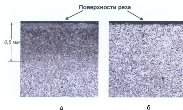
Рис. 3. Микроструктура металла под поверхностью лазерного реза (а) и под поверхностью механического реза (б), x250
