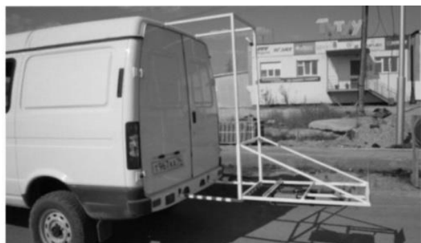
Рис. 1. Автомобильный измерительный комплекс на подвеске автомобиля «Соболь»
