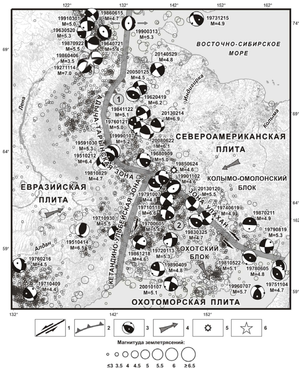
Рис. 1. Схема эпицентров землетрясений и механизмов очагов сильных землетрясений сейсмотектонической зоны Черского (континентальная часть ААСП). Составлена по материалам ГФ РАН и ГС СО РАН: 1–2 – активные разломы: 1 – сдвиги, 2 – надвиги и взбросы; 3 – механизм очагов сильных землетрясений с указанием их даты и магнитуды, белым цветом обозначены области сжатия; 4 – направление движения литосферных плит и блоков; 5 – вулкан Балаган-Тас; 6 – полюс вращения плит. В кружках цифрами обозначены составляющие сегменты сейсмотектонической зоны Черского: 1 – Яно-Инди-гирский; 2 – Индигиро-Кольский
