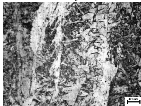
Рис. 2. Микроструктура наплавленных слоев зоны 1, выполненных НМТ (а) и НПТ (б), \times 500
