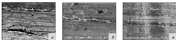
Рис. 5. Типичное микростроение поверхности износа образцов стали, испытанных при числе циклов трения 18000: а – сталь после РКУП; б – сталь после обработки РКУП+350 °С; в – сталь после обработки РКУП+450 °С; \times 1000
