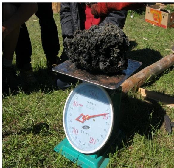
Рис.2. Выплавленная крица из руды Ленского рудного поля
