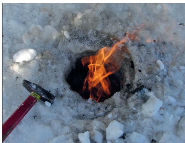
Рис. 6. Выброс природного газа из скважины 1с-16, поднимающегося из пробуренных талых подрусовых грунтов через толщу речной воды.
