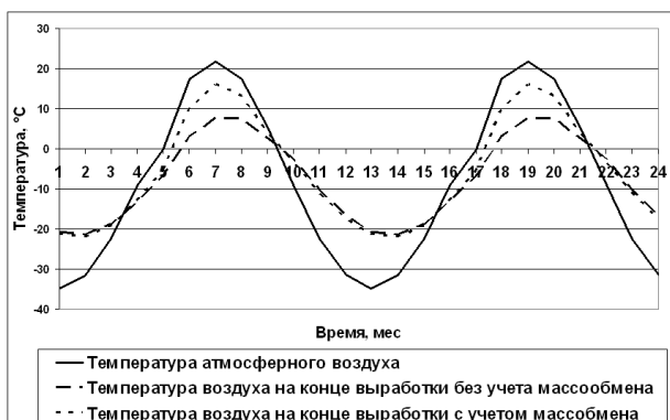
Рис. 1. Динамика температур воздуха на начальном и конечном участках воздухоподающей выработки длиной 1500 м
