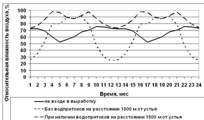
Рис. 2. Динамика относительной влажности воздуха на начальном и конечном участках выработки длиной 1500 м
