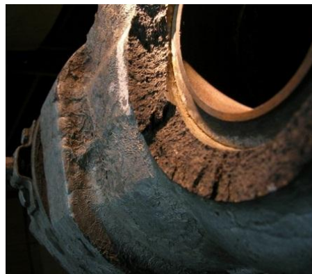
Рис. 3. Строение излома задвижки фонтанной арматуры
