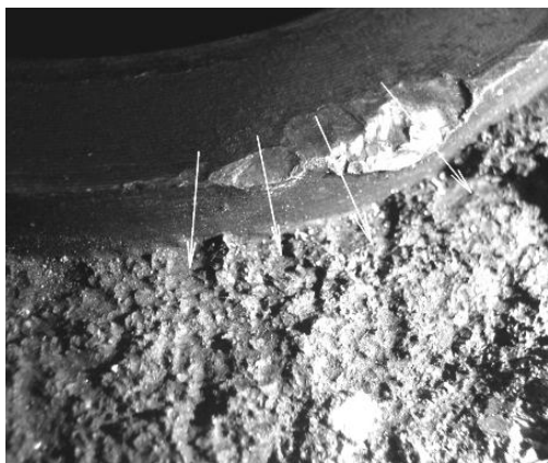
Рис. 6. Схема излома задвижки
