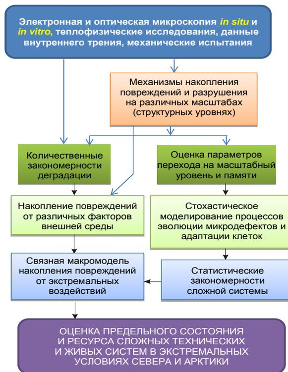
Рис. 1. Схема оценки ресурса сложных систем на основе подхода многоуровневого структурного моделирования
