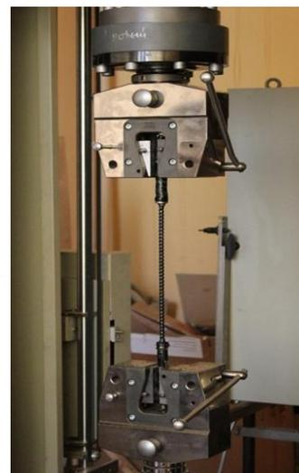
Рис.4. Нагружение образцов на растяжение
