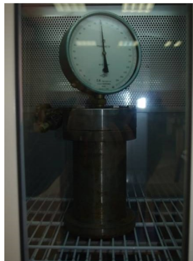
Рис. 2. Общий вид стальной камеры-реактора объемом 1113 см 3 в инкубаторе-холодильнике SANYO MIR-254
