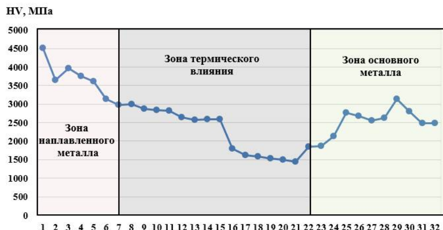
Рис. 4. Распределение микротвердости металла по толщине образца, наплавленного порошковой проволокой на материал коронки ковша экскаватора
