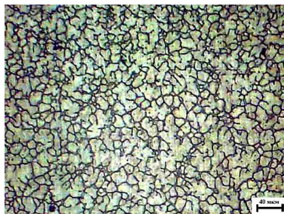
Рис. 3. Микроструктура наплавленного слоя, полученного порошковой проволокой, х500
