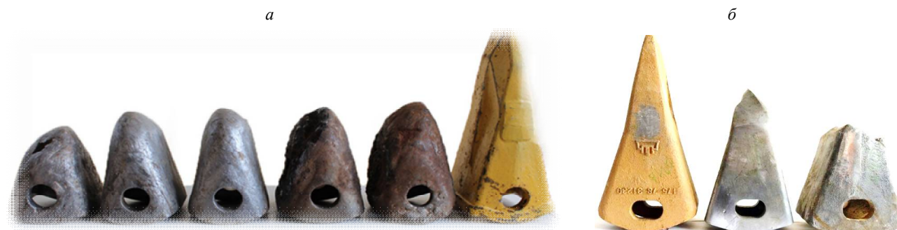
Рис. 1. Изношенные коронки зубьев ковша экскаватора Komatsu PC400-7 (а) и рыхлителя бульдозера Komatsu D155A-5 (б) по сравнению с начальными размерами коронки в состоянии заводской поставки (желтый цвет)
