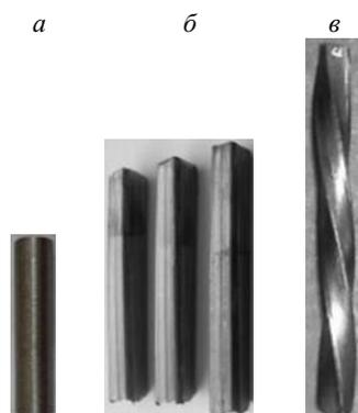
Рис. 2. Исходная заготовка (а), заготовки после экструзии (б), заготовка после ЭВП (в)
