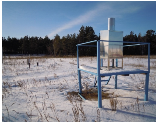
Рис. 1. Площадка мониторинга снежного покрова и установка по сбору атмосферных осадков
