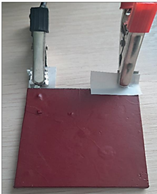
Рис. 1. Прототип нагревательного элемента
