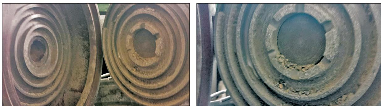
**Рис. 8.** Скопление неразрушенных частиц на отбойных элементах.
