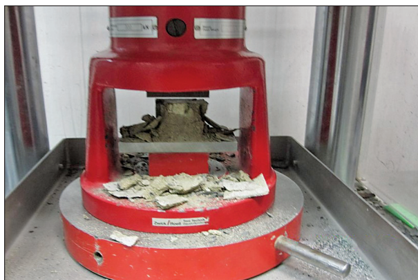
Рис. 2. Разрушение образца на гидравлическом прессе Toni NORM.
