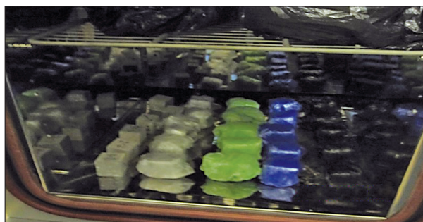
Рис. 3. Образцы в морозильной камере при –5 °С.
