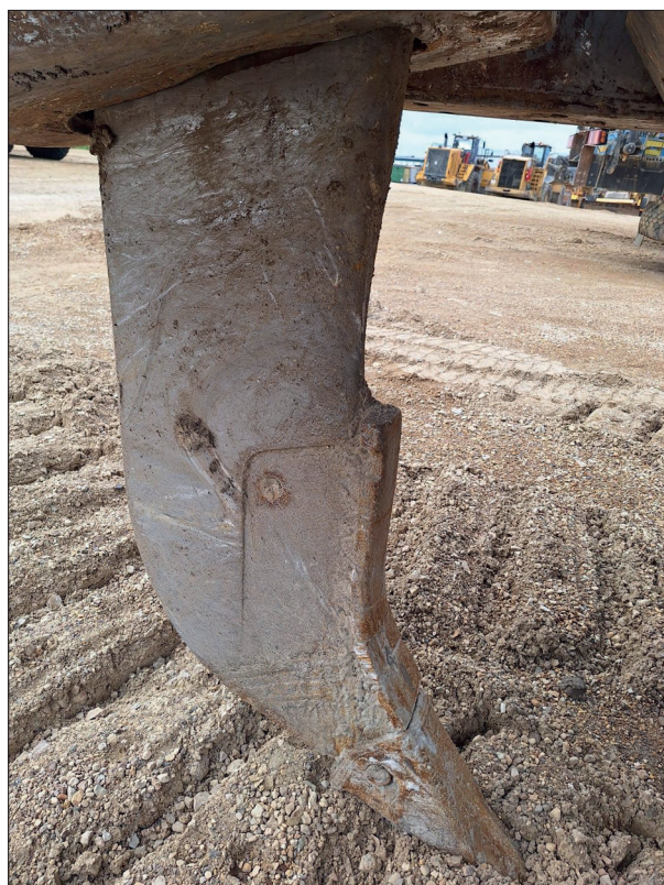
Рис. 3. Стойка рыхлителя бульдозера Komatsu D375 со значительным износом
