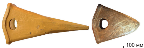
Рис. 1. Новая и изношенная коронки рыхлителя бульдозера Komatsu D375A
