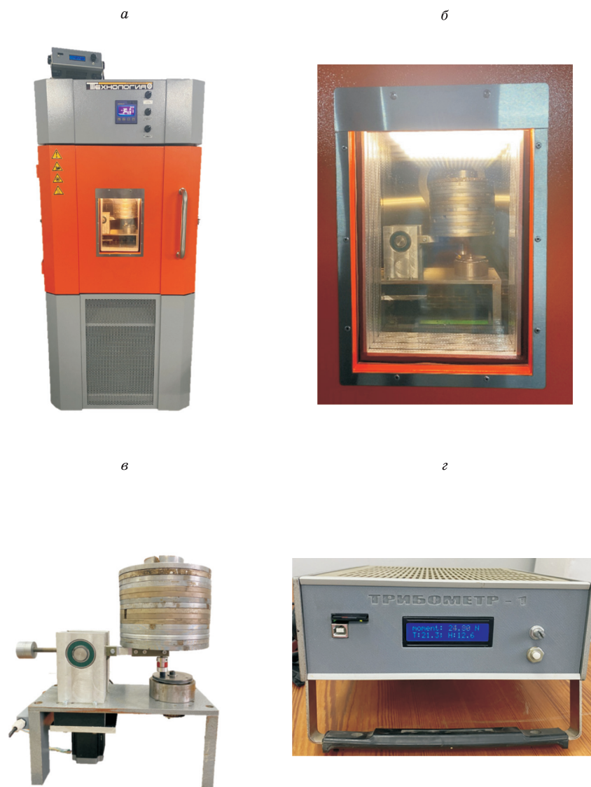
Рис. 1. Экспериментальная установка «Трибометр-1», разработанная в ИПНГ СО РАН: а – расположение в испытательной камере тепла-холода «КТХ-150»; б – проведение исследования в испытательной камере; в – внешний вид экспериментальной установки; г – передняя панель «Трибометра-1»
