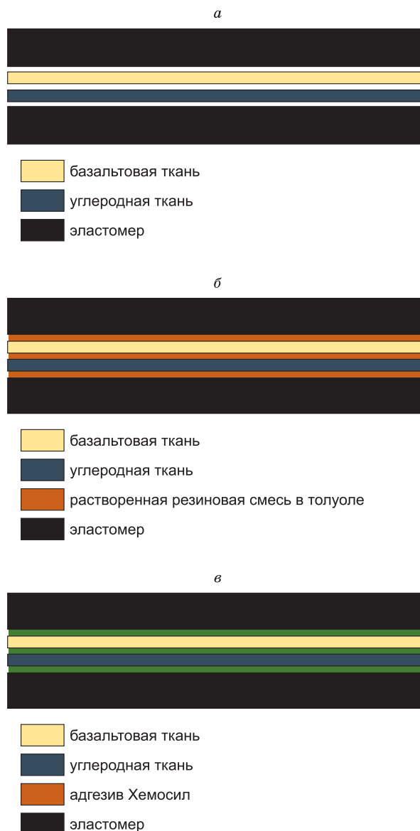
Рис. 1. Схема укладки армирующего наполнителя в эластомер: а – исходная БТ с УТ, уложенные между слоями эластомера; б – обработанные растворенной смесью БТ с УТ, уложенные между слоями эластомера; в – обработанные адгезивом Хемосил БТ с УТ, уложенные между слоями эластомера
