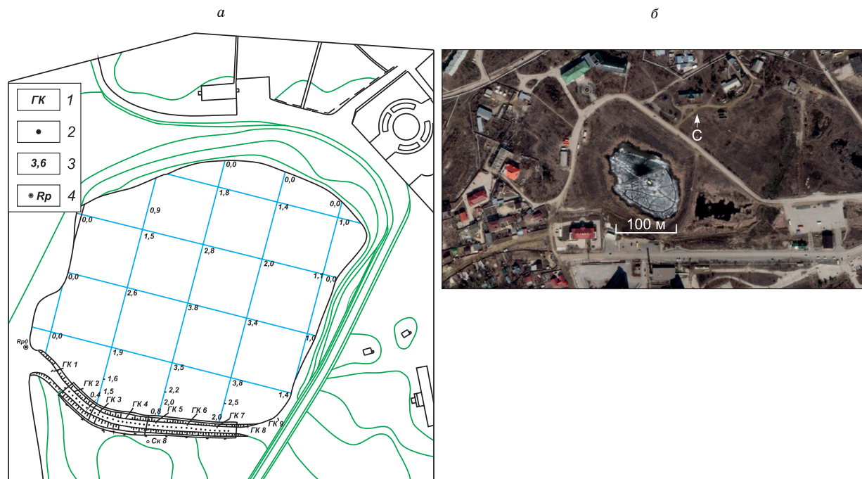
Рис. 1. План озера и дамбы, сентябрь 1982 г. (а): 1 – пикетаж, 2 – термосифоны, 3 – глубина воды в озере (август 1982 г.), 4 – реперный знак; и космоснимок озера и дамбы, 2000 г. (б)
